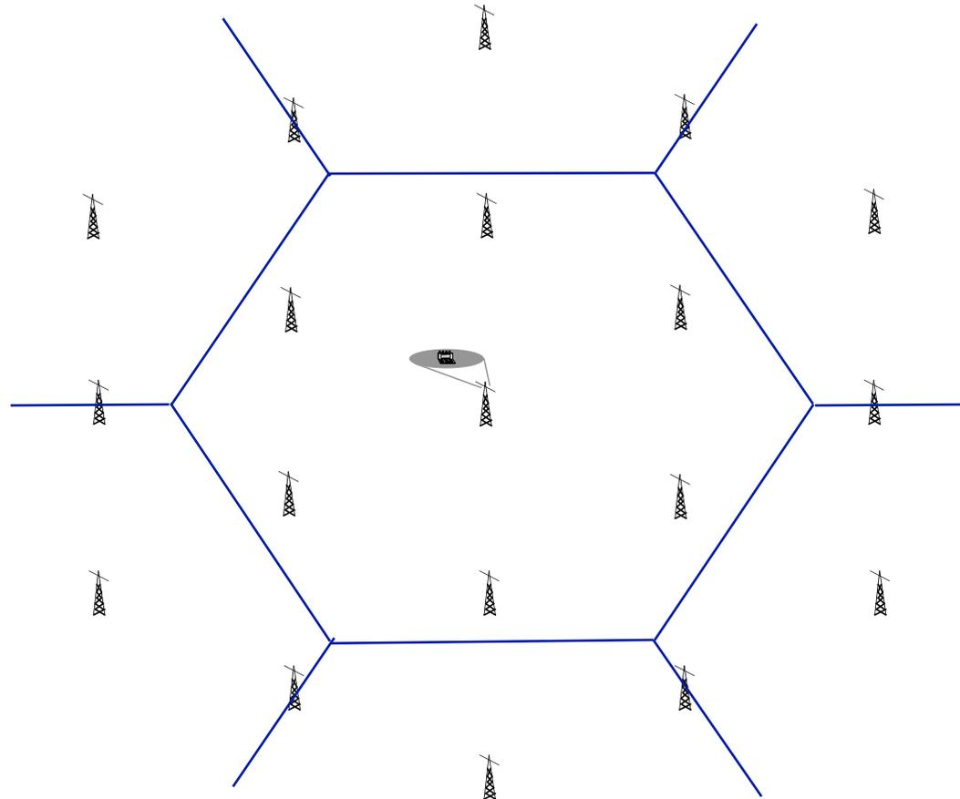
$$\text{SINR}_i = \frac{P_i}{\underbrace{\sum_{j \in 1^{\text{st}} \text{ tier}} P_j}_{\text{circled}} + \sum_{j \notin 1^{\text{st}} \text{ tier}} P_j + N} \quad \Rightarrow \quad \text{SINR}_i = \frac{P_i + \sum_{j \in 1^{\text{st}} \text{ tier}} P_j}{\sum_{j \notin 1^{\text{st}} \text{ tier}} P_j + N}$$
